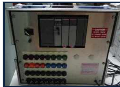
Allen Bradley SLC 5/03
