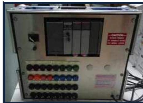
Allen Bradley SLC 5/03
