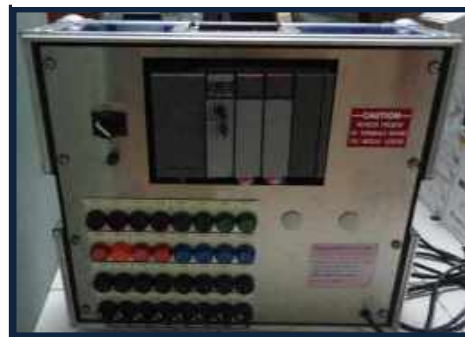
Allen Bradley SLC 5/03
