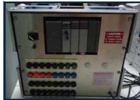
Allen Bradley SLC 5/03
